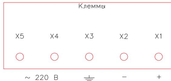
Рис.2. Схема подключения нагрузки к инвертору через обходную цепь
